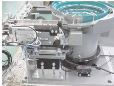
このパーツフィーダは0.5×0.2tの超微細ワークを整列搬送しています。
