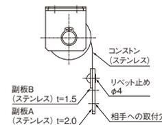
ドラム軸の中心とブラケットの取付け穴2個の中心とは、2.5mmズレています。
