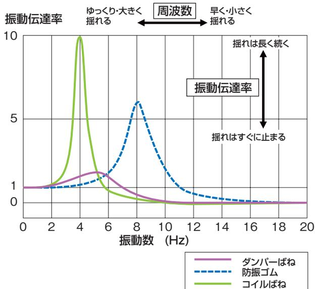
・振動伝達率=応答加速度/入力加速度
